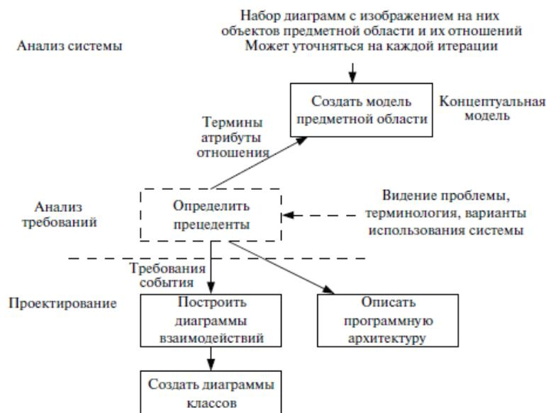
Рис. 7.2. Стадии разработки проекта
