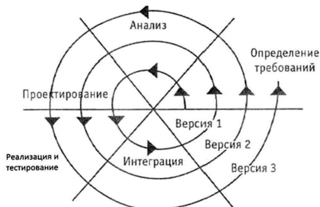
Рис. 8.4. Спиральная модель разработки программного обеспечения
