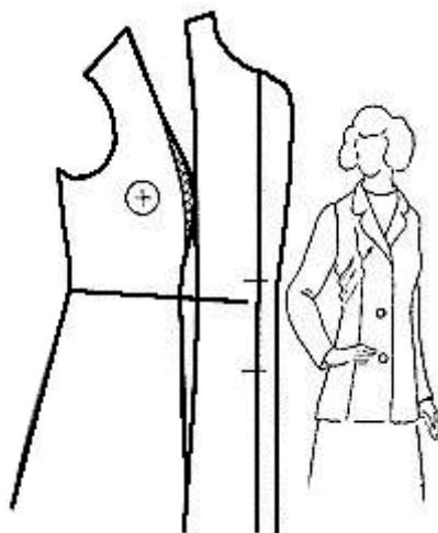
Рис. 18. Недостаточная выпуклость верхней части полочки
